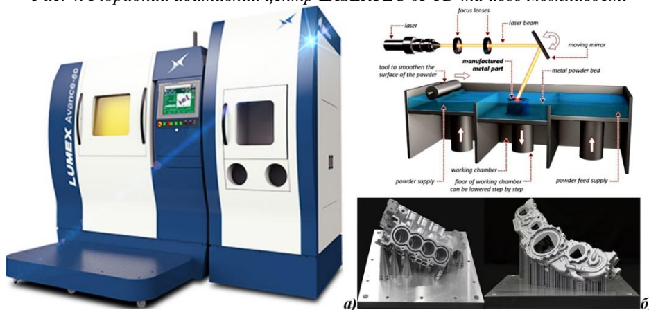
Рис. 5. Hybrid Metal 3D Printer LUMEX Avance-60 (а), його АМ і виробу (б)
