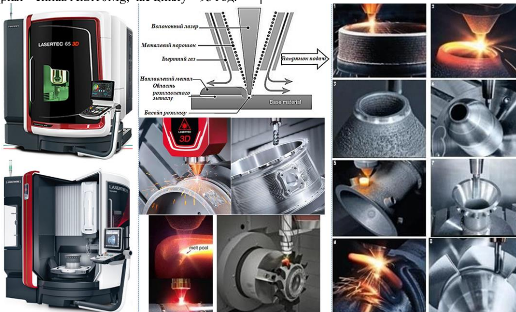
Рис. 4. Гібридний адитивний центр LASERTEC 65 3D та його можливості
