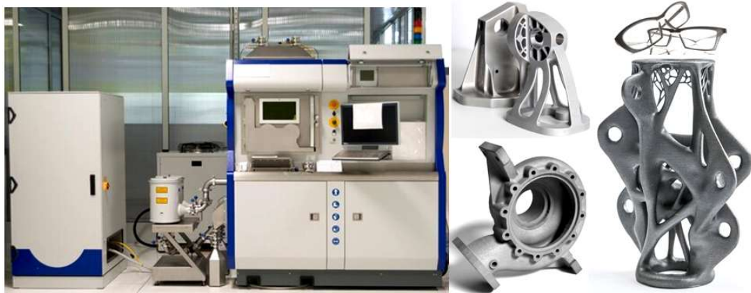
Рис. 4. DMLS-принтер і його титанові вироби
