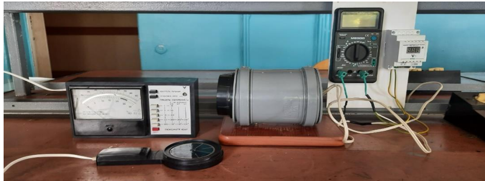
Рис.1. Установка для визначення параметрів LED ламп.
