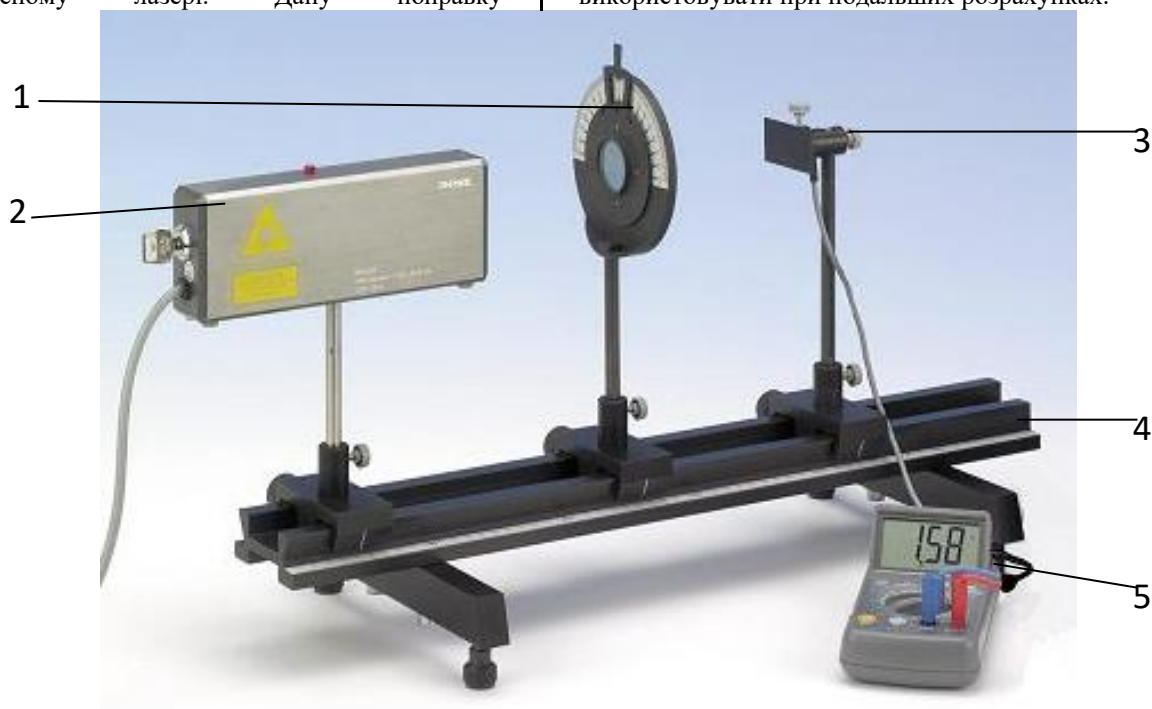
Рис. 1. Експериментальна установка для перевірки закону Малюса: 1 - поляризаційний фільтр, 2 - лазер, 3 - фотоелемент, 4 - оптична лава, 5 - цифровий мультиметр.
