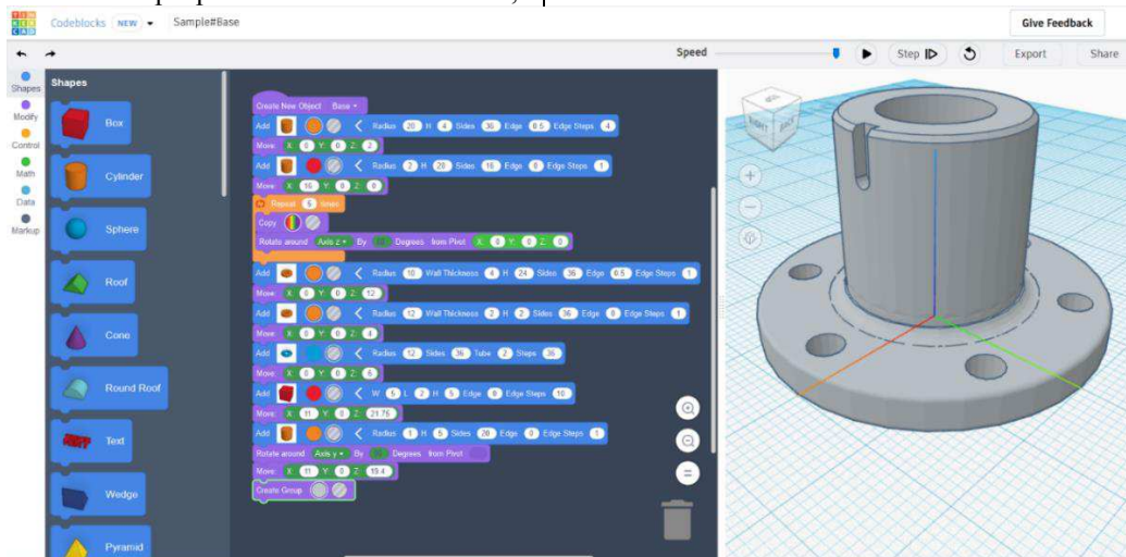
Рис. 3. Побудова просторової моделі за допомогою інструментарію режиму Codeblocks
