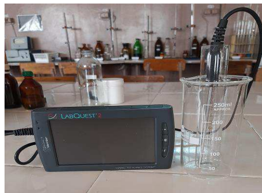
Рис. 2. Установка для проведення ендотермічної та екзотермічної реакції
