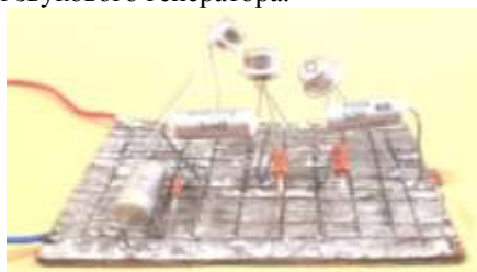
Рис. 2. Зовнішній вид макетної плати звукового генератора
