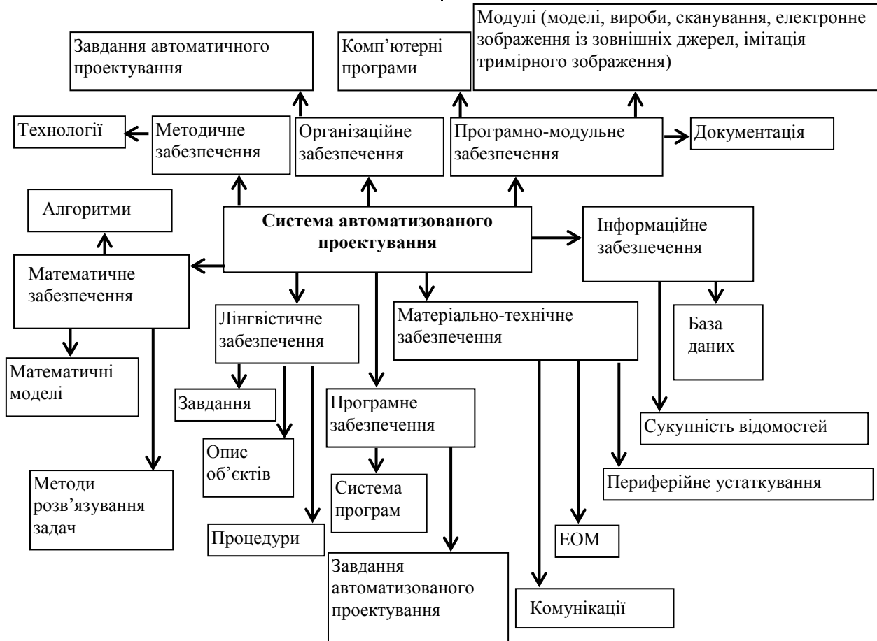
Рис. 13. Структурно-логічна схема системи автоматичного проектування
