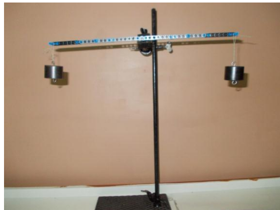
Рис. 7. Демонстрація правила важеля.
