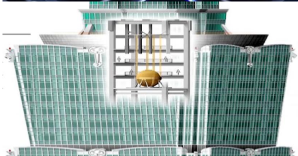
Рис. 4. Система балансування для хмарочосів
