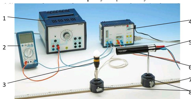
Рис. 1. Установа для перевірки закону Стефана-Больцмана:
