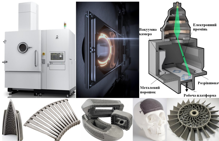
Рис. 7. АТ Electron Beam Melting та її вироби
